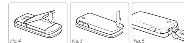
Fig. 4 : insérer la batterie, les contacts de la batterie doivent toucher les contacts dorés du téléphone portable.
